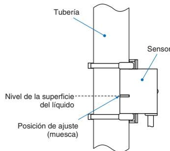
2. Después de instalar el sensor, ajuste la sensibilidad de detección utilizando el potenciómetro (12 pasos) de sensibilidad de la forma que se muestra a continuación.
