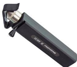
Herramienta para realizar cortes circulares, longitudinales o espiralados, permitiendo quitar la vaina en cualquier punto del cable de una manera rápida y más fácil. Ideal para cables de PVC tipo Sintenax desde  $4,5$  hasta  $25\text{mm}$  de diámetro. Construcción robusta para el uso continuo. Posee una cuchilla extra de reemplazo en la base.
