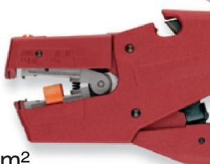
Versión económica del pelacables Stripax de Weidmüller. Herramienta construida con plástico de alto impacto, obteniendo una mayor vida útil y menor peso. Corta y desvaina cables flexibles o rígidos, con vaina de PVC desde  $0,08$  hasta  $6\text{mm}^2$  de sección. Posee un tope para ajustar la longitud a desvainar y un regulador para adaptar las cuchillas según el espesor de la vaina.
